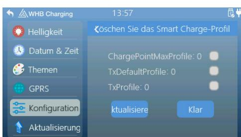
Markieren Sie das entsprechende Optionsfeld im Menüpunkt „Clear Smart Charge Profil“ und bestätigen Sie mit Klar die hinterlegten Einstellungen.
