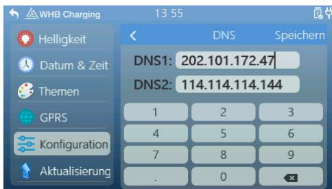
Der DNS wird hauptsächlich in Verbindung mit dem Ethernet-Modus verwendet. Wenn der DNS über den Domänennamen aufgerufen wird, muss er konfiguriert werden. Wenn er nicht konfiguriert ist, verwendet das System standardmäßig den internen Standard-DNS zur Auflösung.
