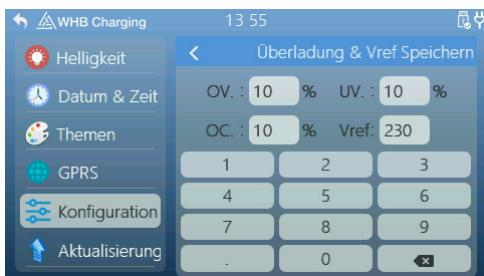
Die maximale Überlast beträgt 20 %. Der Ladevorgang endet automatisch nach 5 Sekunden kontinuierlicher Überlast, Überspannung und Unterbewertung.
