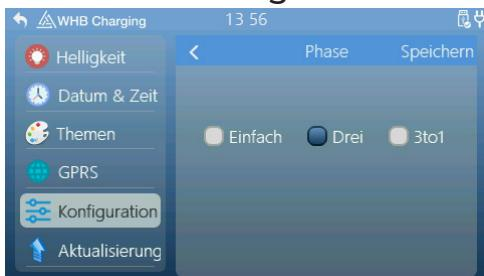
Die Ladestation unterstützt den einphasigen und dreiphasigen Anschluss. Ein dreiphasiger Anschluss kann auf den einphasigen Modus umgeschaltet werden. Einphasige Anschlüsse können nicht auf dreiphasig umgeschaltet werden.
