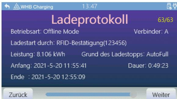
Die Hauptinformationen, die auf der Oberfläche des Ladeprotokolls angezeigt werden, umfassen die Transaktionsseriennummer, die registrierte Kartennummer, die Ladeleistung, Start- und Endzeit des Ladevorgangs, die Ladedauer und den Grund für das Beenden des Ladevorgangs.
